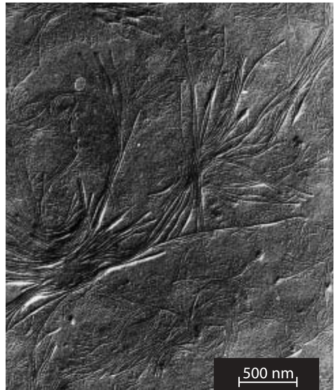
Abbildung 3: Aufnahme eines Polytetrahydrofuran-reichen PA 12-Elastomers mit dem Transmissions-Elektronenmikroskop
