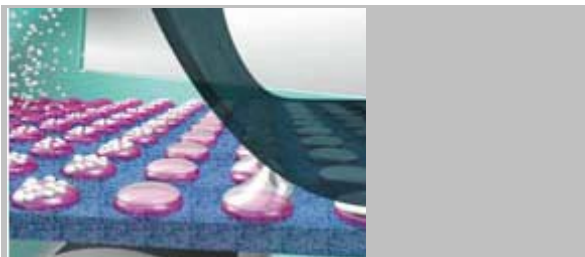
Verhalten der Beschichtungspunkte beim Doppelpunkt-Beschichtungsverfahren
